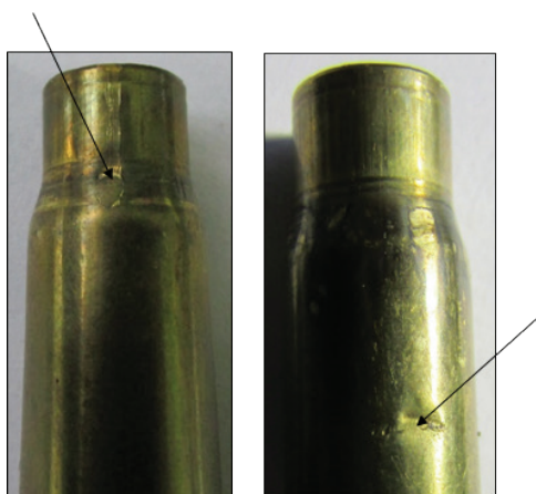
Рис. 3. Зображення криміналістичної мітки на гільзах, стріляних з мисливського карабіна «Форт-201» калібру 7,62x39 мм.
