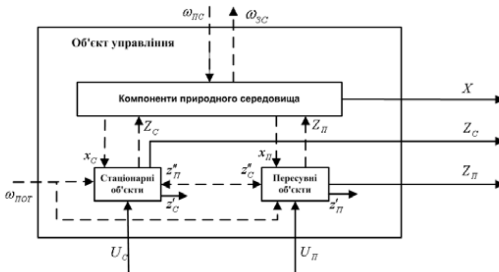
Рис. 1. Узагальнена модель управління екологічною безпекою територій, що зазнають впливу промислових об'єктів і транспорту
