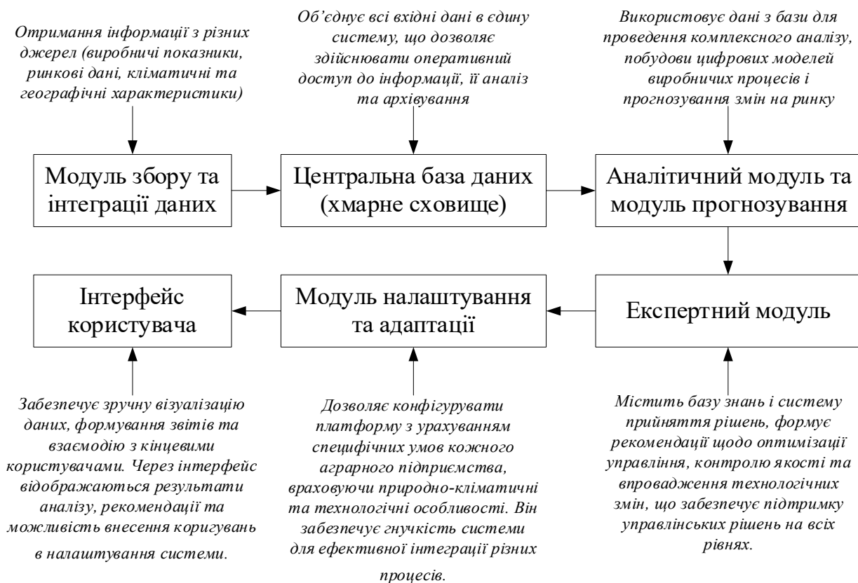
Рис. 1. Структурна схема запропонованої інтелектуальної платформи
