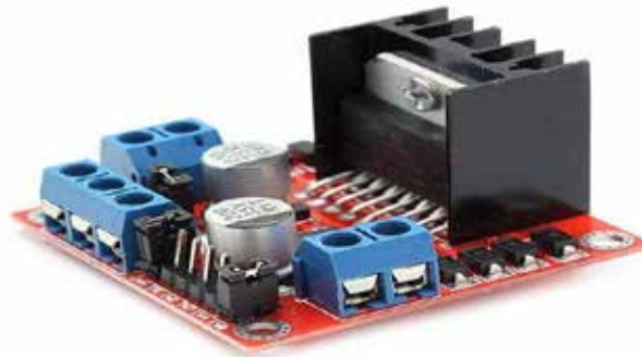
Рис. 3. Драйвер двигунів L298N
