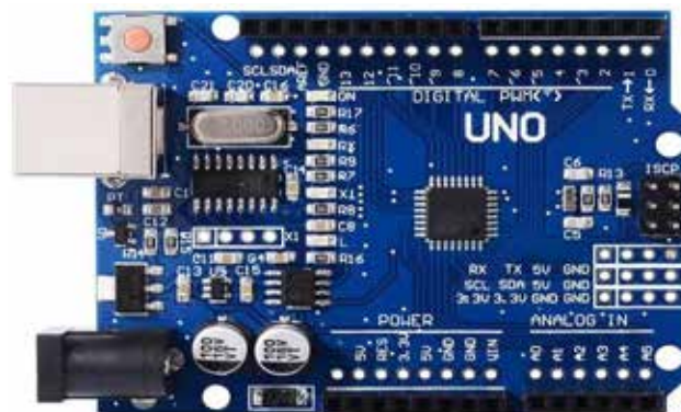
Рис. 1. Контролер Arduino Uno R3
