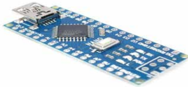
Рис. 2. Контроллер Arduino Nano V3
