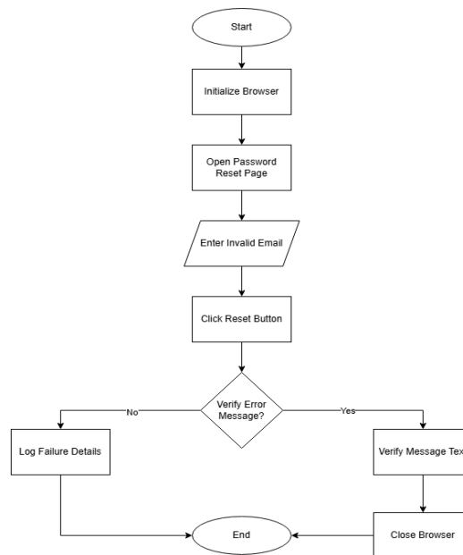
Рис. 2. Блок-схема сценарію скидання пароля з некоректною електронною адресою
