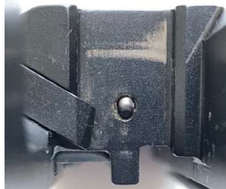
Рис. 7. Збільшене зображення передніх зрізів чашок затвора пістолетів зі слідоутворюючими частинами (зліва направо): «Glock-26» та «Glock-43X».
