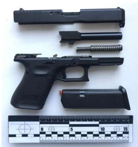
Рис. 3. Пістолет «Glock-19» п'ятого покоління (Gen 5) у частково демонтованому стані.
