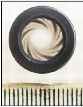
Рис. 9. Нарізи в каналі стволу пістолета 2-го покоління.
