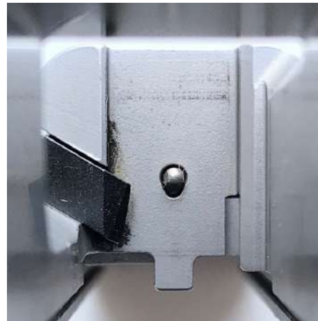
Рис. 8. Збільшене зображення переднього зрізу чашки затвора пістолета «Glock-48» зі слідоутворюючими частинами.
