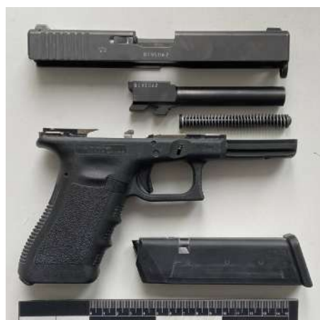
Рис. 2. Пістолет «Glock-17» калібру 9x19 мм третього покоління у частково демонтованому стані.
