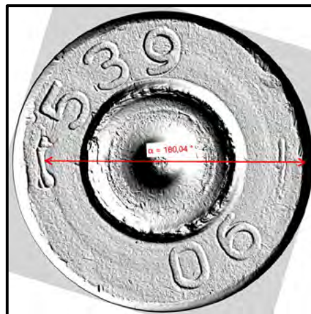
Ілюстрація № 2. Збільшене зображення переднього зрізу гвинтівки снайперської спеціальної «Вінторез» та слідів від частин зброї на дні гільзи (бійка ударника на капсулі, зачепу викидача на фланці гільзи та відбивача на дні гільзи
