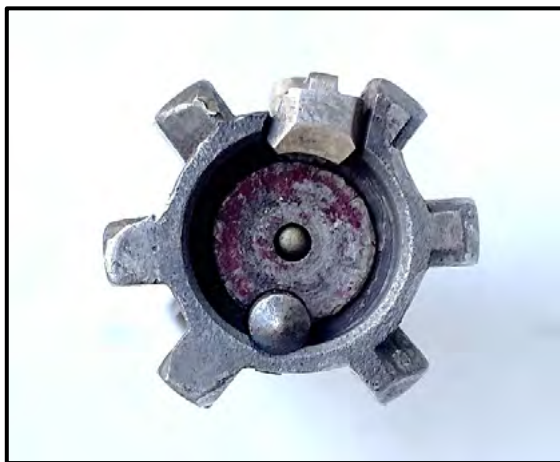
Ілюстрація № 2. Збільшене зображення переднього зрізу гвинтівки снайперської спеціальної «Вінторез» та слідів від частин зброї на дні гільзи (бійка ударника на капсулі, зачепу викидача на фланці гільзи та відбивача на дні гільзи
