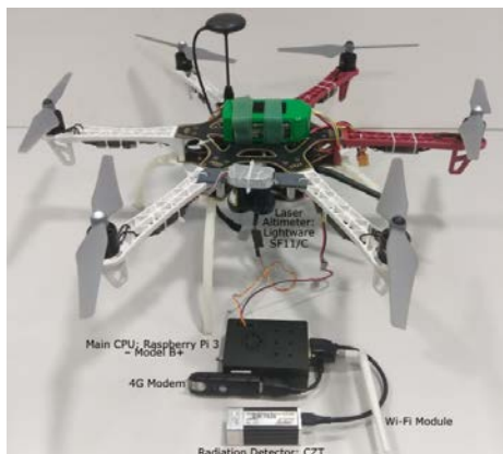
Рис. 3. Безпілотна літальна платформа з бортовим обчислювальним обладнанням [28]
