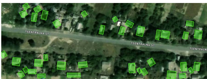
Рис. 5. Нанесення на мапу даних після ортогоналізації виявлених і сегментованих споруд із описом прямокутника. Фрагмент вулиці Центральна, населеного пункту Нова Гребля (50.58441 29.89059), Київська область
