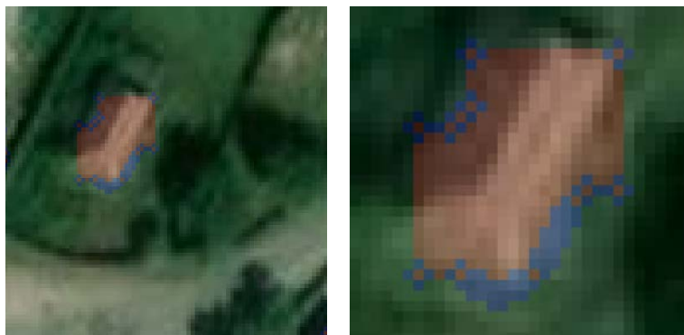
Рис. 4. Ортогоналізація сегмента. Ключові вершини обведені синім кольором
