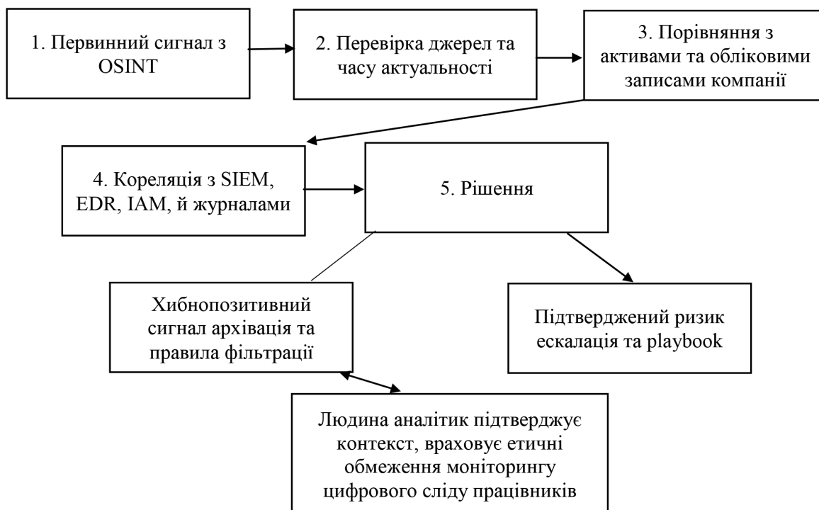
Рис. 3. Процес верифікації зовнішніх індикаторів та кореляції з подіями SIEM
