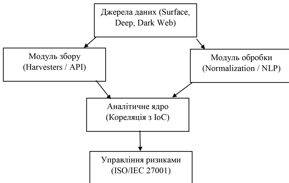
Рис. 1. Структурна модель компонентів системи Enterprise OSINT
