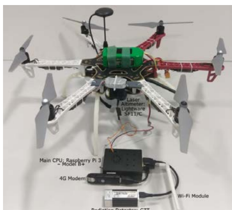
Рис. 3. Безпілотна літальна платформа з бортовим обчислювальним обладнанням [28]
